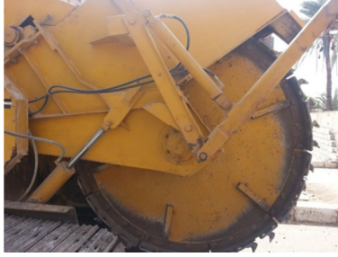
صورة رقم ٤:معدة تستخدم لقطع الأسفلت
